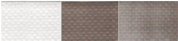
Membrane PVC-P blanche avec armature, mais sans couche de protection
